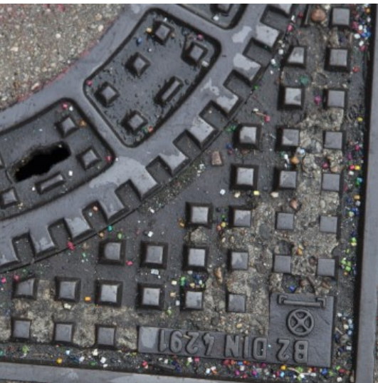
Abbildung 5: Industrielles Mikroplastik am Regenkanal
