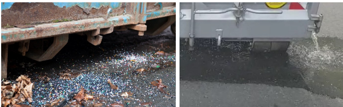
Abbildung 15: Hoffläche an Abrollcontainer bei der Leerung vor und nach Erneuerung der Mulde
