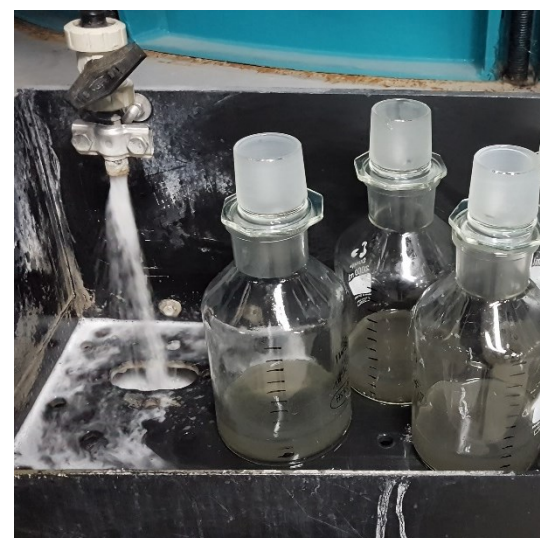
Abbildung 9: Erstellung von Mischproben (1 l)
