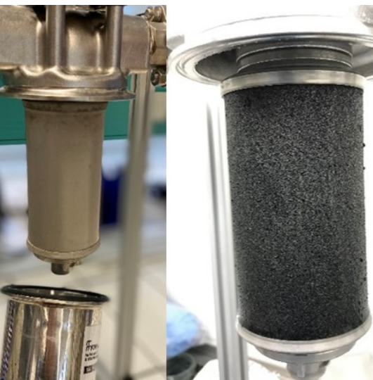
Abbildung 11: Edelstahlkerzenfilter zur Probenahme
