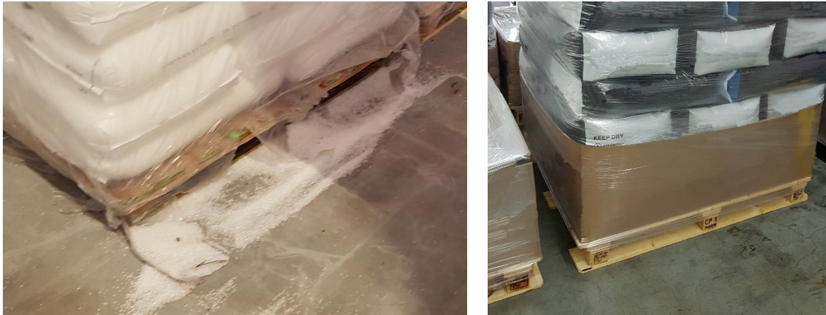
Abbildung 16: Beschädigung an Sackware (links) wird durch entsprechende Verpackungen (rechts) vermieden
